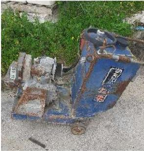
Imagem 19 – Máquina cortar alcatrão
