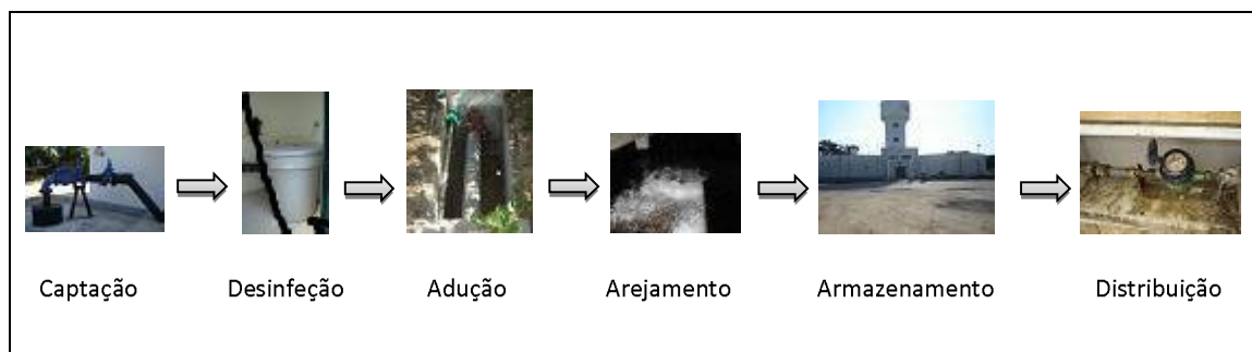
Figura 8: Diagrama de fluxo do sistema de abastecimento.
